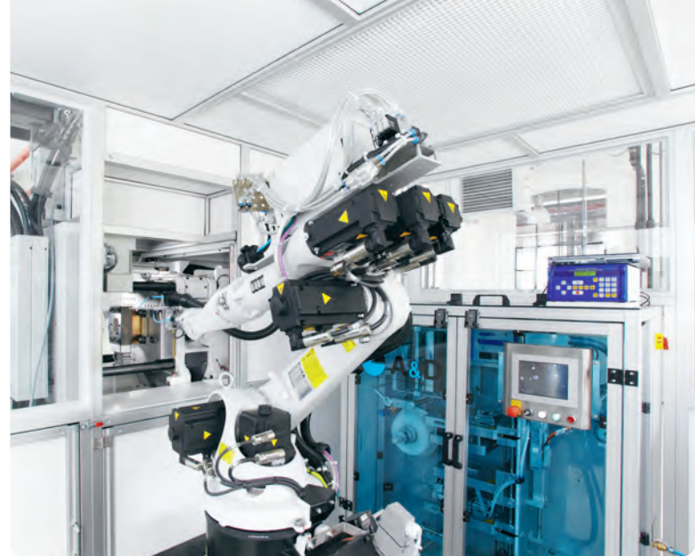
Sechs-Achs-Roboter mit pneumatischen Greifern zur schonenden Entnahme der fertigen Spritzteile. (Bild: Arburg)
