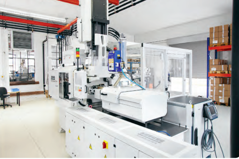
Zweikomponenten-Spritzgießmaschine mit Reinraumkabine: Hier entstehen anspruchsvolle Spritzteile, zum Beispiel für die Medizintechnik. (Bild: Arburg)
