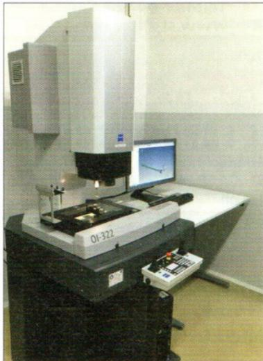
Mit einem neuen Zeiss-Koordinatenmessgerät zur optischen oder wahlweise taktile Vermessung von Spritzgießteilen baut die Pfaff GmbH ihre Qualitätssicherung
